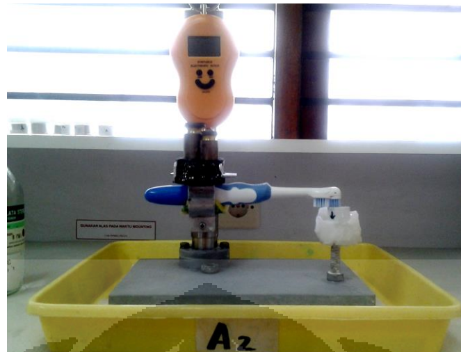
Gambar 4.6 Prosedur Penyikatan Spesimen
