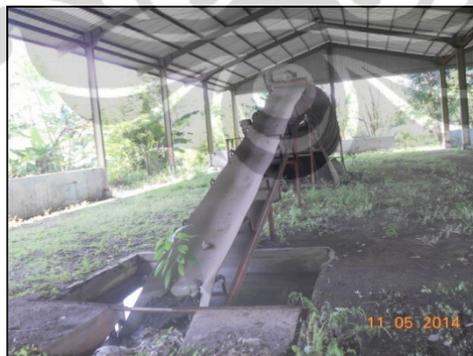
**Gambar 5.1 Mesin Pencacah di Pabrik Kompos**
