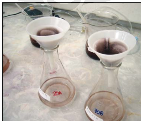
Gambar 3.17. Penyaringan larutan leaching
