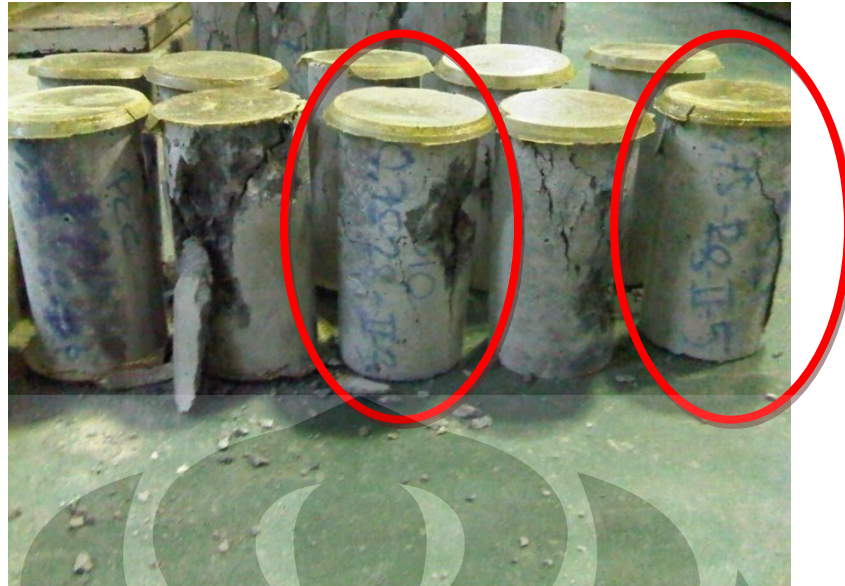
Gambar 4. 13 Pola Retak Tidak Merata pada Sampel TK-0,75-II-3 dan TK-0,75-II-5
