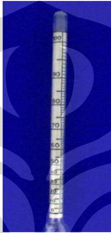
Gambar 2.7. Skala pada *alkoholometer*
