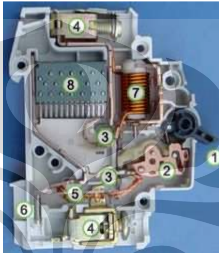
Gambar 2.37. Komponen-komponen dalam suatu MCB 1 phase
