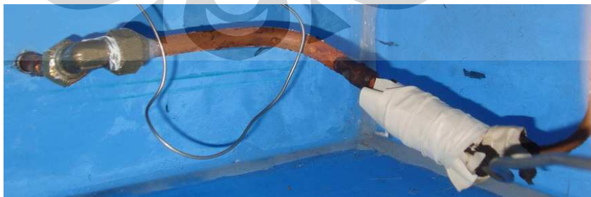
Gambar 3.42. Thermocouple pada inlet Evap
