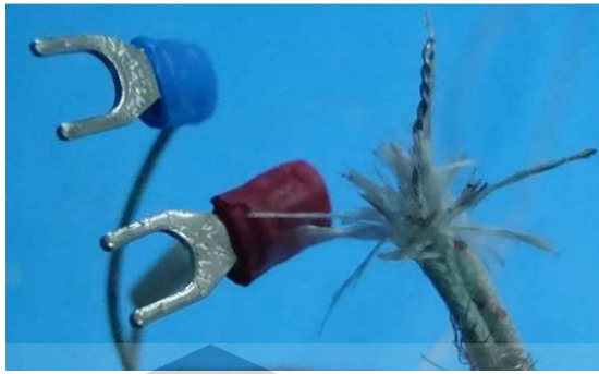
Gambar 3.37. Thermocouple yang dipergunakan
