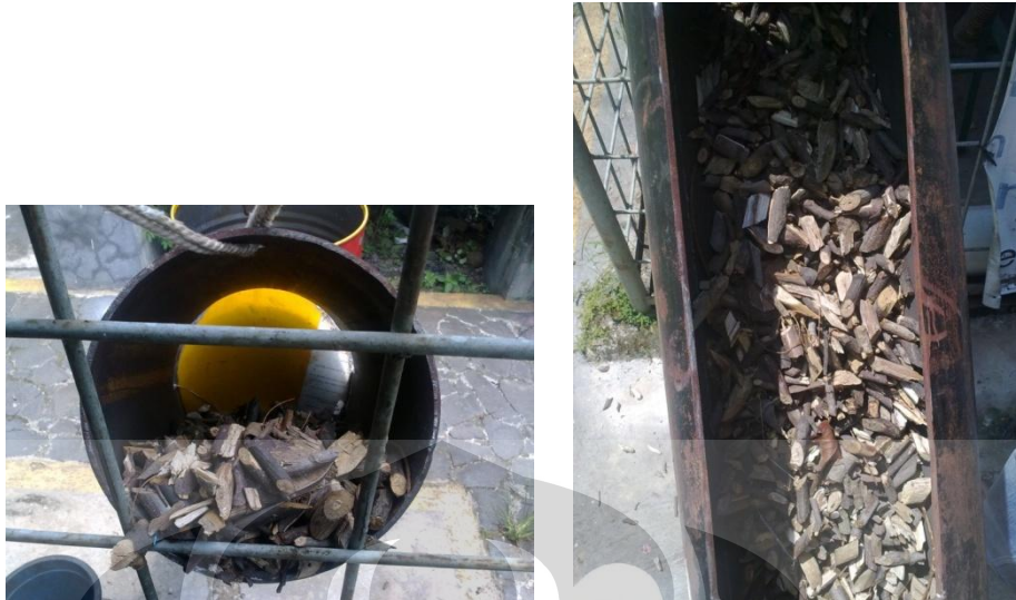
Gambar 3.4 Kedudukan Ranting saat di Dalam Pipa Model Feeder
