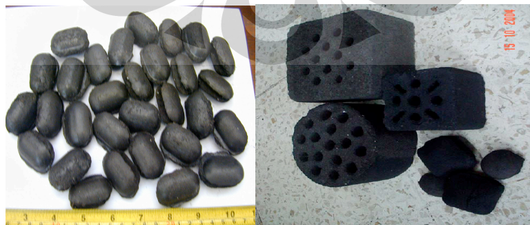
Gambar 2. 5 Briket bentuk telur, sarang tawon dan bantal
