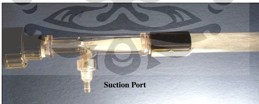
Gambar 2.9. Udara terhisap masuk ke dalam injektor venturi dan ribuan gelembung kecil terbentuk setelah suction port
