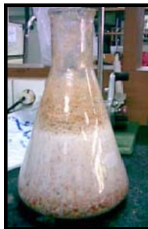
Gambar 4.2 Tahap Demineralisasi Cangkang Rajungan dengan HCl 1 M.
