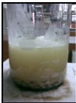
Gambar 4.4 Tahap Deasetilasi Kitin menjadi Kitosan dengan NaOH 50%
