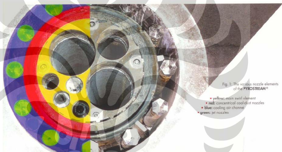
Gambar 2.31 Teknologi *Jet Burners* pada *Rotary Kiln*
