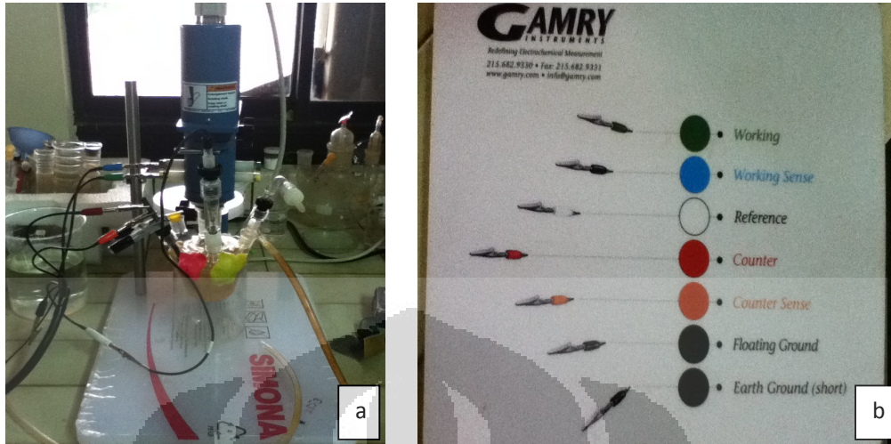
Gambar 3.5 (a) Rangkaian Sel Polarisasi; Gambar 3.6 (b) Panduan pemasangan jepit untuk pembacaan kurva polarisasi pada software Gamry.
