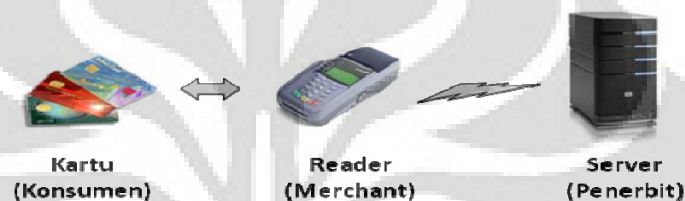
Gambar 3.4 Konfigurasi Sistem Uang Elektronik Berbasis Chip/Offline Bank
