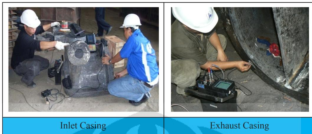
**Gambar 3.17** Pengujian Ultrasonik <sup>[2]</sup>
