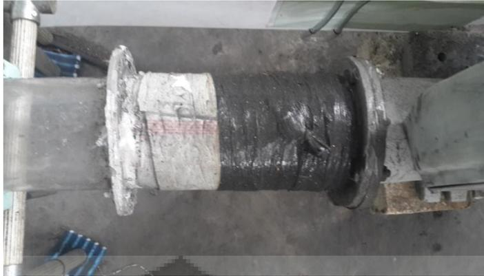
Gambar 3.3. Penyambungan *Blower* dan Venturimeter dengan Lem Silikon
