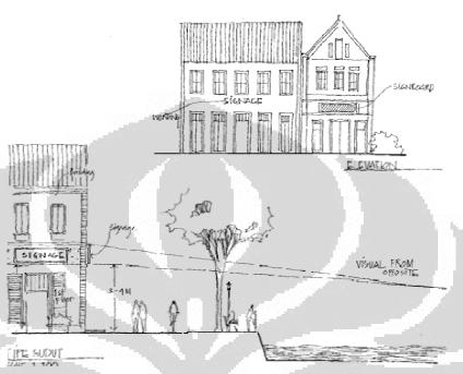
Gambar diatas memperlihatkan penempatan signage pada fasad bangunan dengan pertimbangan prinsip pengaturan / organisasi fasad yang berlaku pada fasad bangunan
