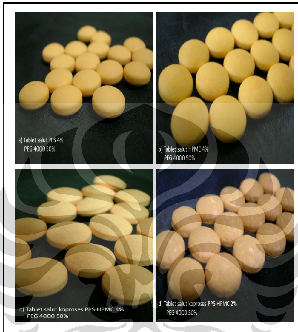
Gambar 4.26. Tablet salut a) PPS konsentrasi 4%, b) HPMC konsentrasi 4%, c) koproses PPS-HPMC konsentrasi 4%, d) koproses PPS-HPMC konsentrasi 2%
