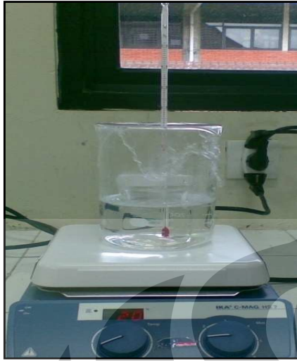
Gambar 43. Alat uji difusi termodifikasi.
