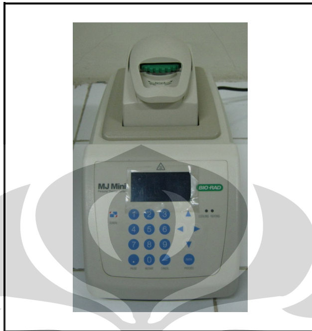
Gambar 4. Thermal Cycler [MJ Mini BioRad]
