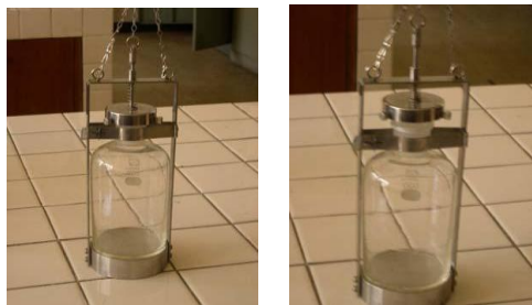
Gambar 2.1 Contoh alat pengambil contoh air sumur gali
