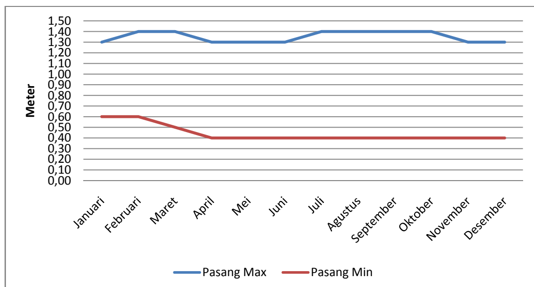
Gambar 5.2 Grafik Tinggi Pasang Minimum Dan Maksimum Di Stasiun Tanjung Priok Tahun 2008 (Sumber : Pengolahan Data 2010)
