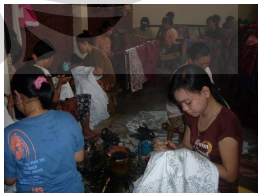
Foto 6. Proses pemberian malam menggunakan canting di Kelurahan Kergon (Hana, 1 November 2010)
