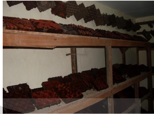
Foto 2. Plat tembaga yang digunakan untuk membuat batik cap (Hana, 1 November 2010)
