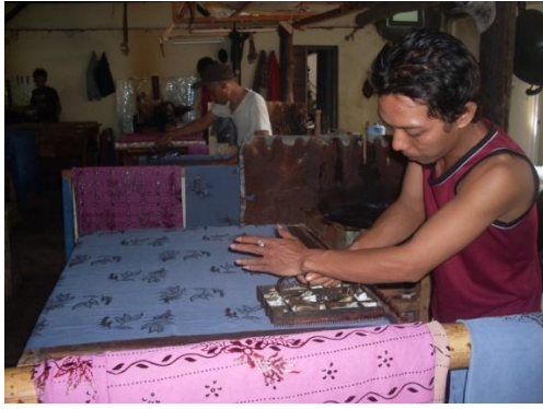
Foto 7. Proses pemberian malam menggunakan plat tembaga di Kelurahan Kergon (Hana, 1 November 2010)
