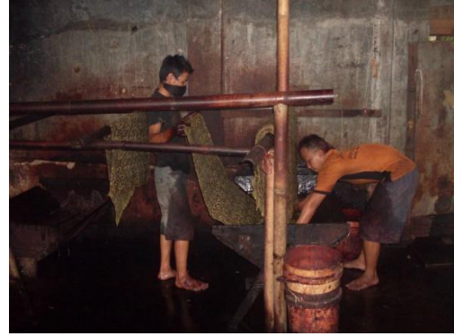
Foto 8. Proses pewarnaan kain batik dengan teknik celup di Kelurahan Banyurip Ageng (Hana, 30 Oktober 2010)
