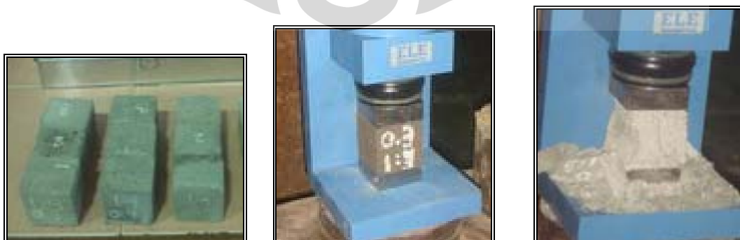
Gambar 4.6. Benda uji, uji kuat tekan, pola retak mortar
