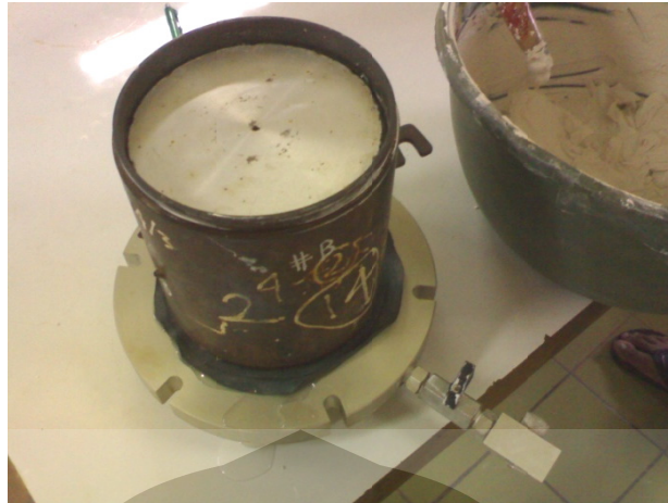
Gambar 3.4. Perakitan mold pada alat Rowe Cell.
