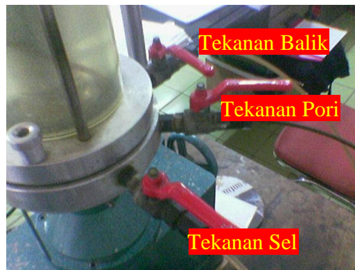
Gambar 3.10 Posisi Katup Saat Saturasi Ketika Tekanan Balik Tidak Bekerja
