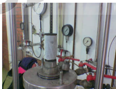
Gambar 3.9 Benda Uji Yang Dilapisi Dengan Tisu
