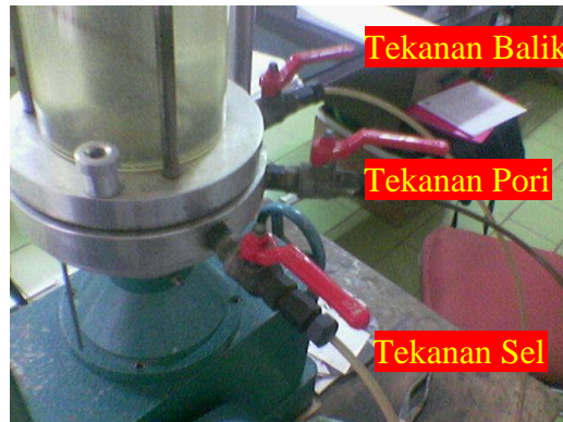
Gambar 3.12 Posisi Katup Saat Saturasi Ketika Tekanan Balik Bekerja
