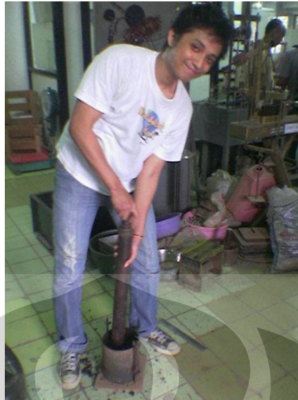
Gambar 3.3 Proses Pemadatan Modified
