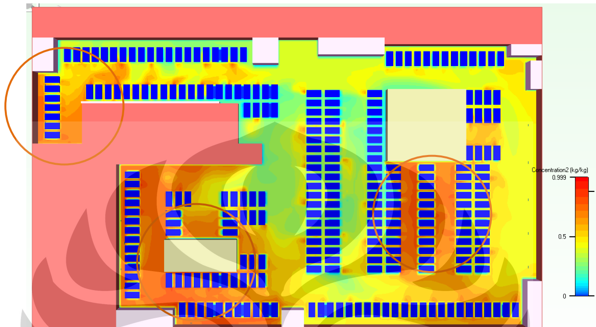
Gambar 4.10 Hasil simulasi aktual penumpukan konsentrasi CO pada Basement 2
