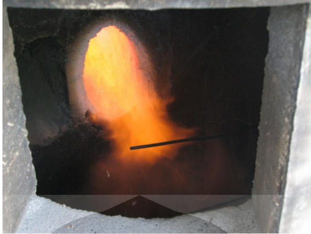
3.2 Api yang Terbentuk Saat Pemanasan Awal dengan Gas Burner
