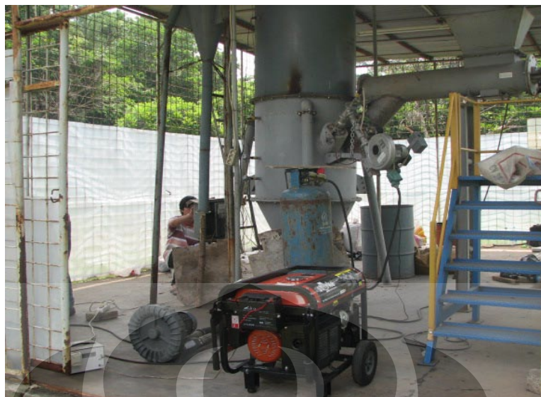
Gambar 3.16 Rangkaian Seluruh Alat untuk Melakukan Pengujian Pembakaran
