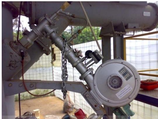
Gambar 2.12 Burner yang Digunakan pada *Fluidized Bed Combustor* UI
