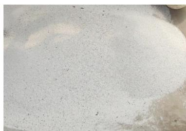
Gambar 3.3 Pasir Silika Mesh 30-50 yang Digunakan pada FBC UI
