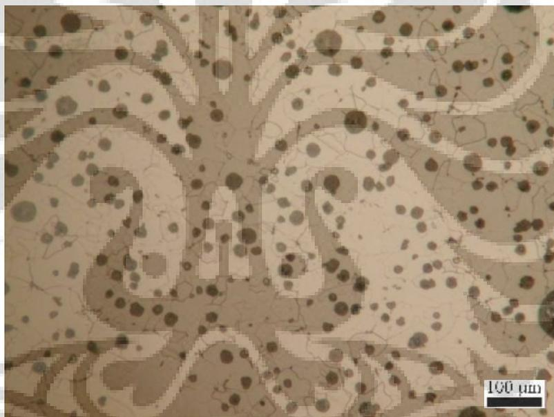
Gambar 4.5 Struktur mikro plat A1 etsa
