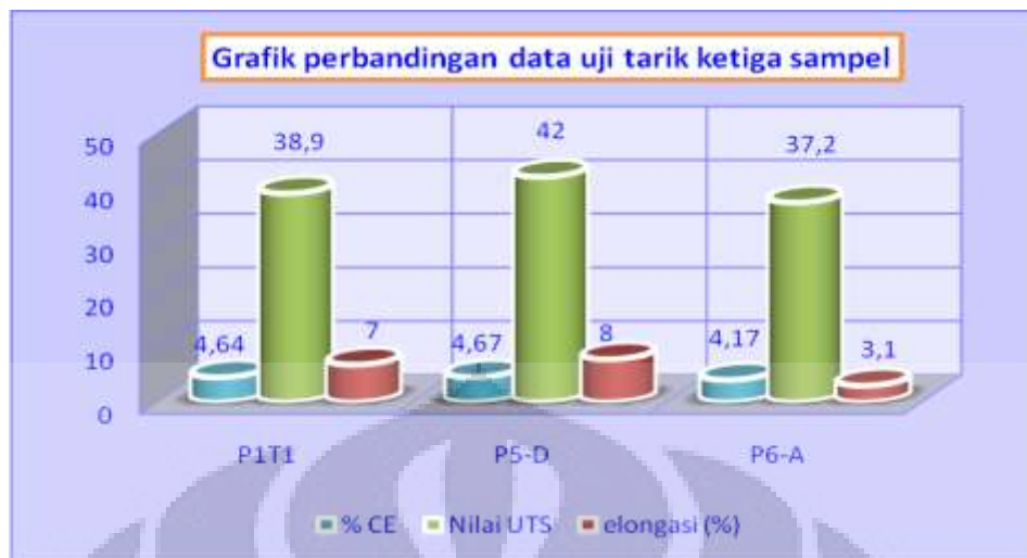
Gambar 4.13 Grafik perbandingan nilai UTS, %elongasi dan nilai CE dari ketiga sampel pada plat 5 mm
