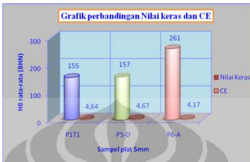
Gambar 4.12 Grafik perbandingan nilai kekerasan dan CE pada ketiga sampel
