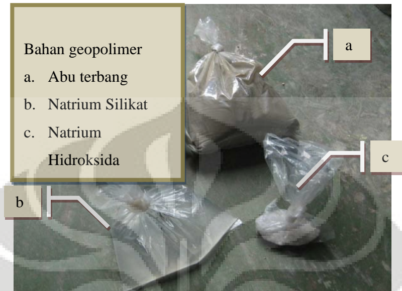
Gambar 4.2 Bahan pembuatan beton geopolimer
