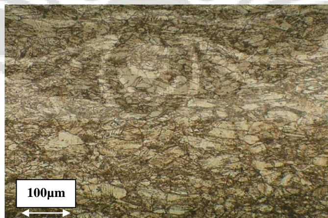
Gambar 4.3. Struktur Mikro Setelah Canai Dingin Posisi Melintang.
