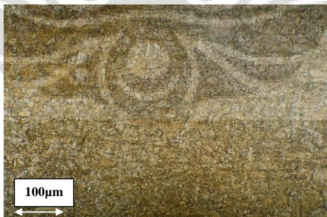
Gambar 4.15. Struktur Mikro Setelah Anil 2 Menit Temperatur 600°C Posisi Melintang.
