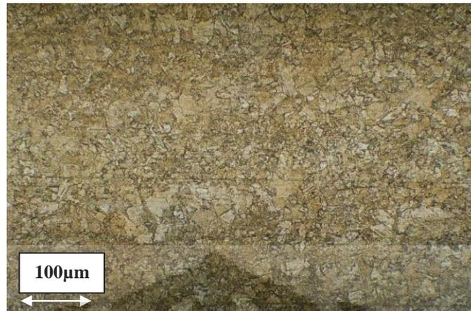
Gambar 4.19. Struktur Mikro Setelah Anil 4 Menit Temperatur 600°C Posisi Permukaan.
