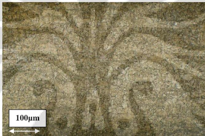
Gambar 4.14. Struktur Mikro Setelah Anil 2 Menit Temperatur 600°C Posisi Memanjang.
