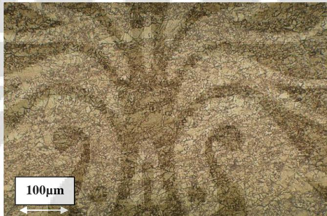
Gambar 4.5. Struktur Mikro Setelah Anil 500°C Waktu Tahan 3 Menit Posisi Memanjang.
