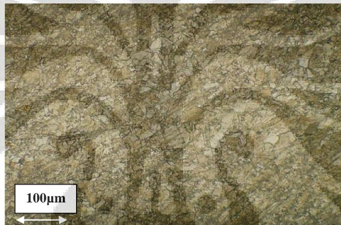
Gambar 4.20. Struktur Mikro Setelah Anil 4 Menit Temperatur 600°C Posisi Memanjang.
