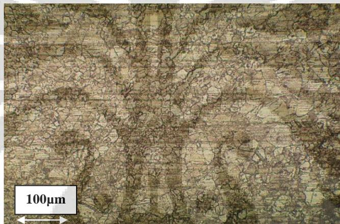
Gambar 4.17. Struktur Mikro Setelah Anil 3 Menit Temperatur 600°C Posisi Memanjang.
