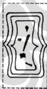
Gambar 4.8 Pembentukan fasa intermetalik dalam sel dendrit
