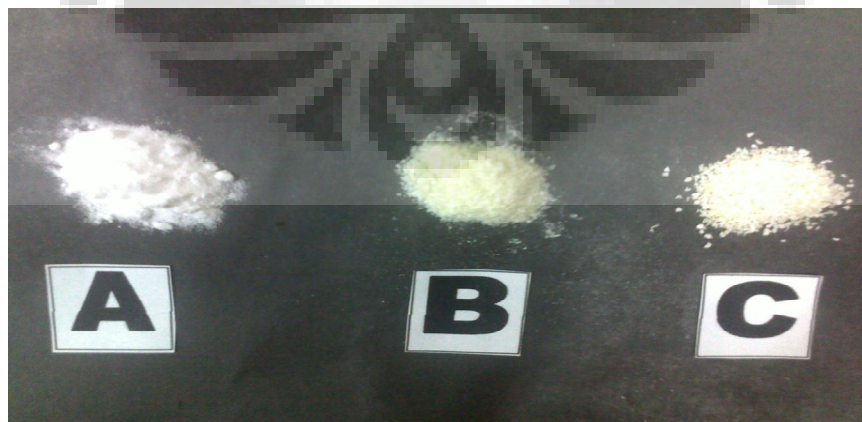
Gambar 4.3. Ftalat anhidrida (A), kitosan (B) dan kitosan ftalat (C)
