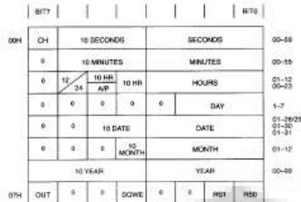
Gambar 2.11. Register-register Pencatat Waktu
