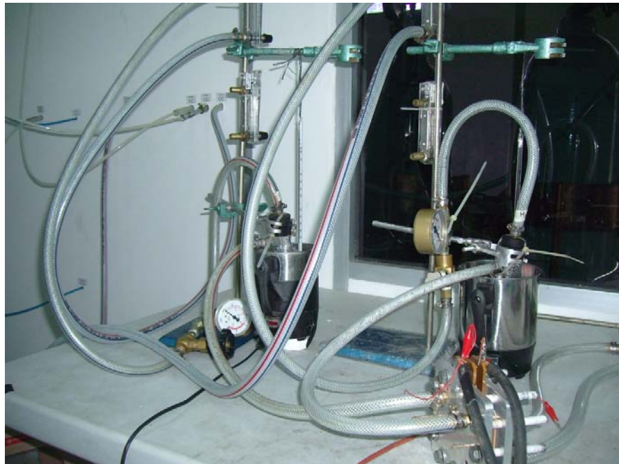
Sistem pengujian dan pengukuran single stack PEMFC
