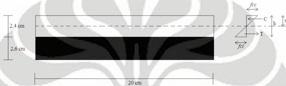
Gambar 4.20. Gambar penampang pelat dan grafik tegangan elastis ketika retak
