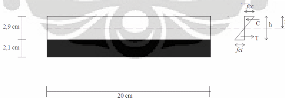
Gambar 4.27. Gambar penampang pelat dan grafik tegangan elastis ketika retak
