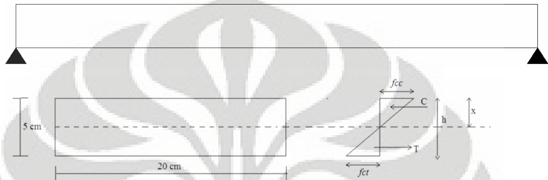
Gambar 4.39. Gambar penampang pelat dan grafik tegangan elastis R 1%
