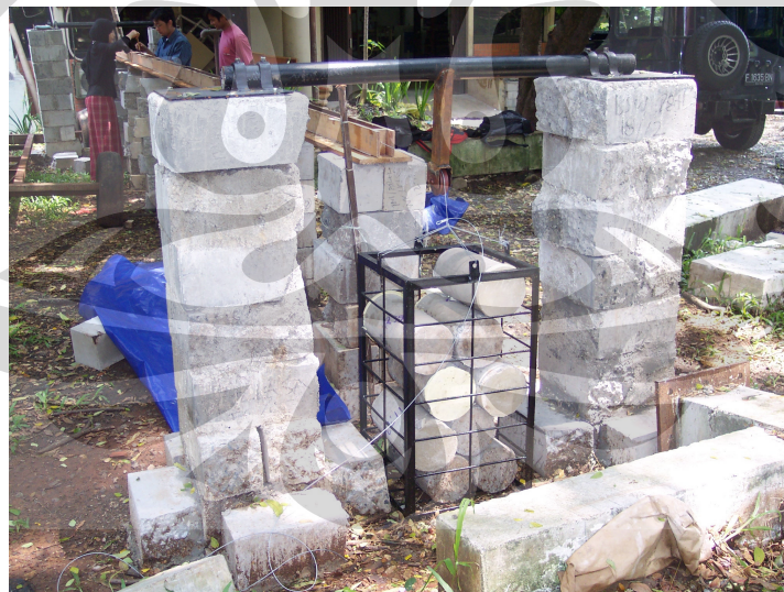
Gambar 3.2. Kolom-kolom sebagai dudukan katrol dan keranjang beban
