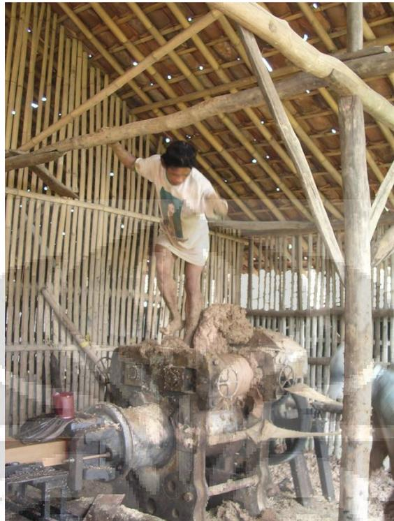
*Gambar 2.2 Cara pemadatan bata dalam mesin cetak*
