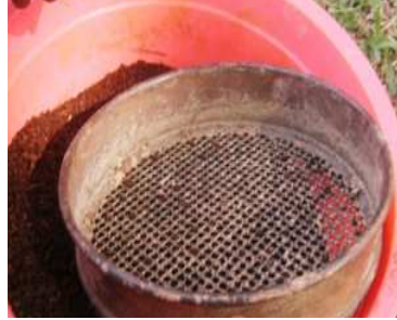
Gambar 3.3 Proses penyaringan contoh tanah dengan saringan no.4
