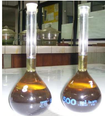
Gambar 3.6 contoh tanah gambut dalam proses pengujian specific gravity
