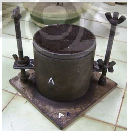
Gambar 3.8 tanah gambut yang telah dipadatkan
