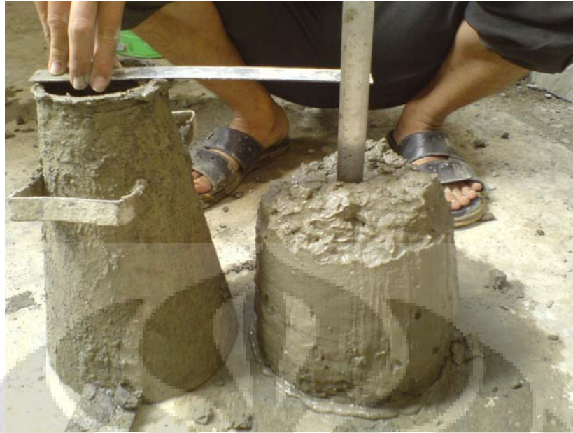
C6.1. Pengukuran Slump Dengan Kadar PET 0%
