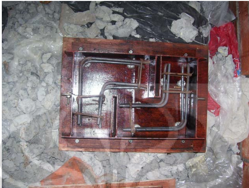
C2.1. Alat Pencetak Double L
