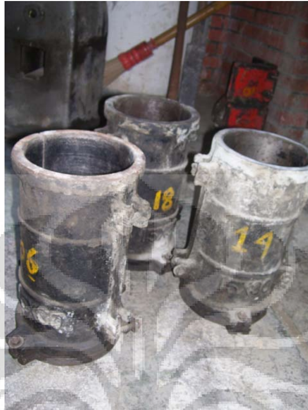
C5.1. Alat Pencetak Benda Uji Silinder
