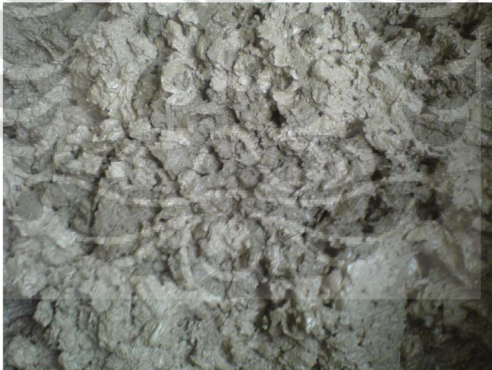
C8.2. Hasil Pengadukan Beton Dengan Kadar PET 0,7%
