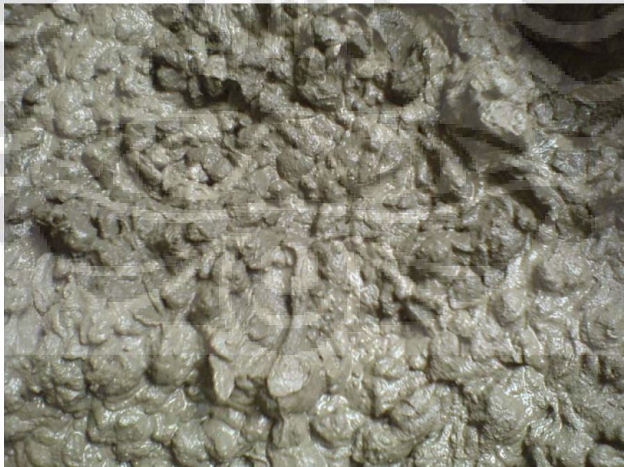
C5.2. Hasil Pengadukan Beton Dengan Kadar PET 0%
