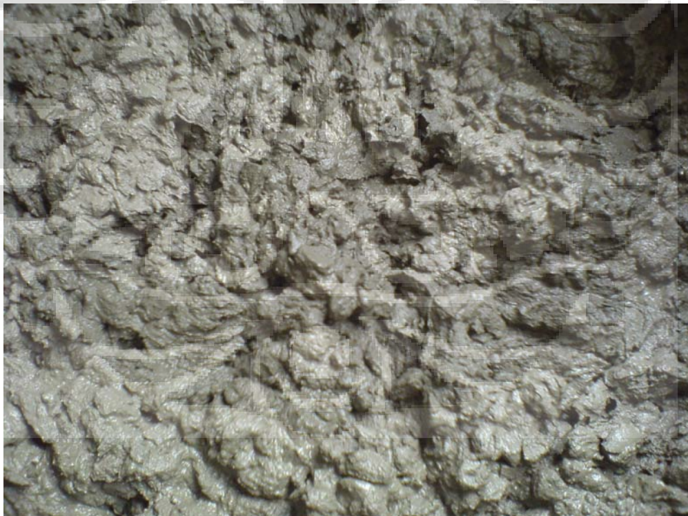
C7.2. Hasil Pengadukan Beton Dengan Kadar PET 0,5%
