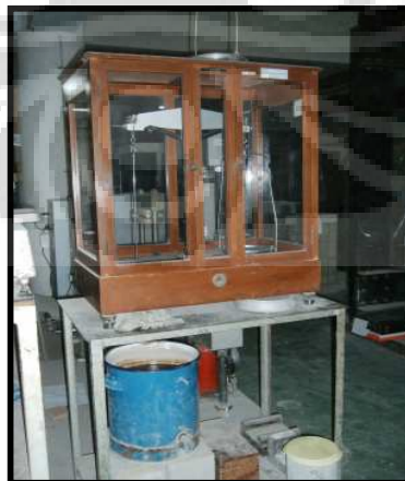
Gambar 3.3 Alat pengujian Specific Gravity pada Agregat Kasar
