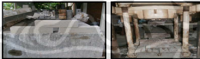
Contoh benda uji dan alat pengujian kuat lentur
