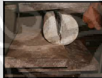
Contoh benda uji kuat geser dan pengujian kuat geser
