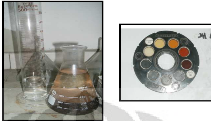
Gambar 3.2 Alat Pengukur Kadar Organik pada Pasir dan Pengujian Kadar Organik pada Pasir Galunggung
