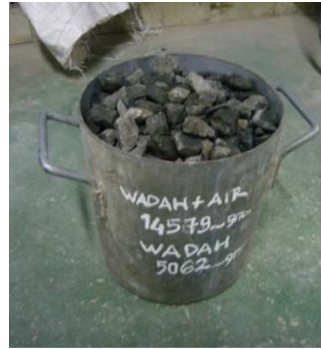
Gambar 3.8. Pengujian berat isi Agregat Kasar
