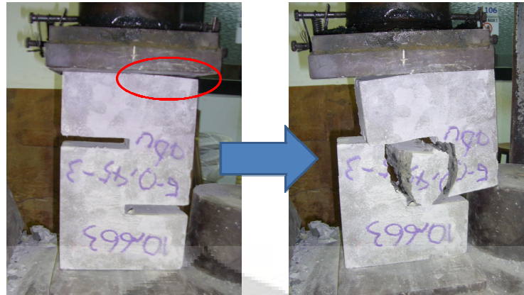
Gambar 4.13 Keretakan tidak ideal pada benda uji geser
