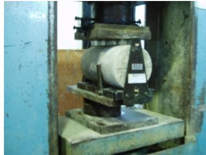
Gambar 3.4. Pemasangan posisi silinder beton dengan bearing strips yang tepat
