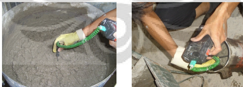
Gambar IV. 11 Pengujian suhu awal beton segar saat pengecoran
