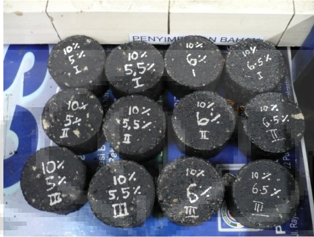
Gambar 4.8. Sampel Marshall dengan Geopolimer 10%
