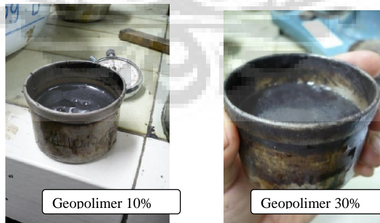
Gambar 4.2. Sampel Penetrasi dengan Penambahan Geopolimer
