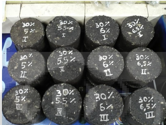
Gambar 4.10. Sampel Marshall dengan Geopolimer 30%
