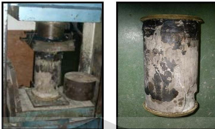
**Gambar 4.9** Pengujian Kuat Tekan Agregat Plastik PP ukuran Silender Diameter 15 cm Tinggi 30 cm
