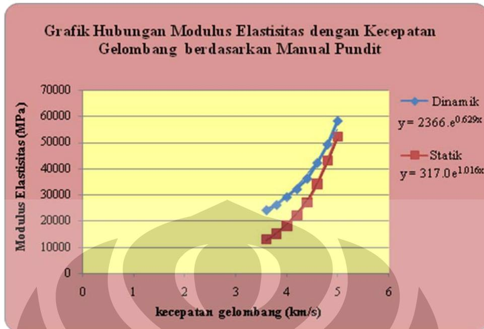
**Gambar 4.28** Kurva Modulus Elastisitas (E) dengan kecepatan gelombang(km/s) berdasarkan manual Pundit
