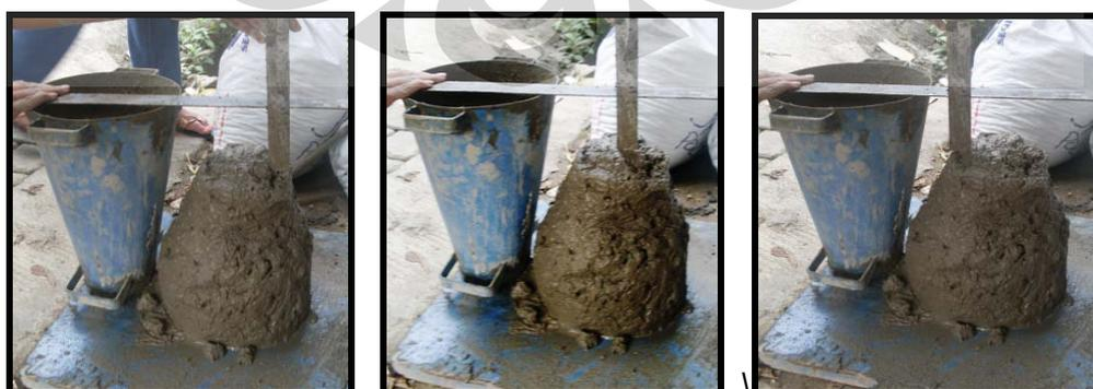
**Gambar 4.12** Pengujian Slump (II)
