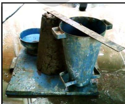
**Gambar 4.11** Pengujian Slump (I)
