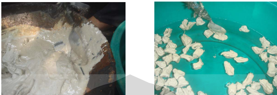
Gambar 4.1. Cara Pembuatan Agregat Kasar Ringan Plastik HDPE Berserat Metal Staples
