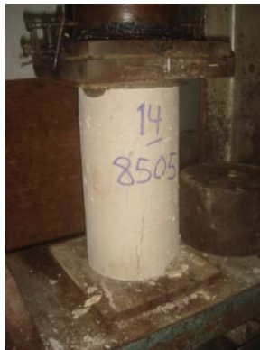
Gambar 4.16. Pengujian Kuat Tekan Beton Ringan Umur 14 Hari
