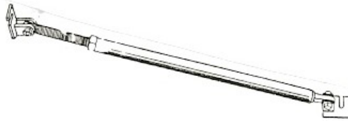
Gambar 2.25: Stempel Sekrup yang dapat disetel (Wigbout, 1992)
