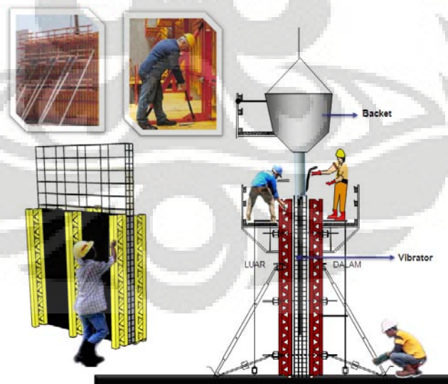
Gambar 2.46: pelaksanaan bekisting retaining wall langkah keempat (Sumber PT Adhi Karya Divisi Konstruksi I)
