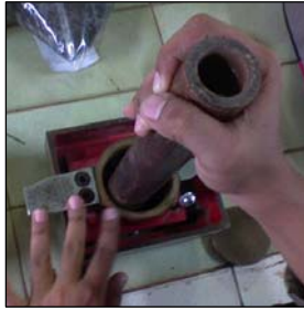
Gambar 3.11. Pemadatan yang dilakukan dalam shear box
